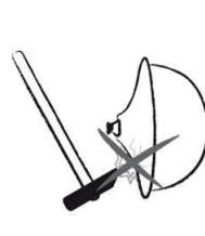
Die Dochtspitze kann nur befestigt und gelöst werden mit dem beiliegenden Schloss! Beim Befestigen und Lösen der Dochtspitze, muss der Schutz in die richtige Position gedreht werden, dass der Schlüssel in die Rillen am Boden des Dochtspitze passt.
